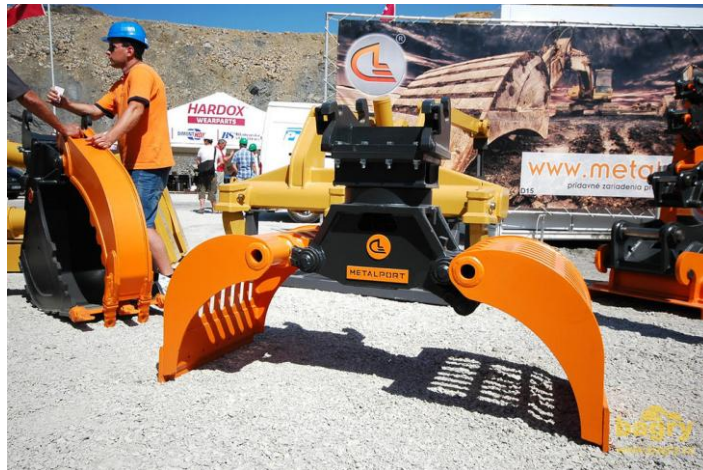
Obr. 15 - Bourací drapák s třídícím efektem [19]
