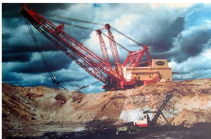
Obr. 3 - Rypadlo s vlečným korečkem [13]
