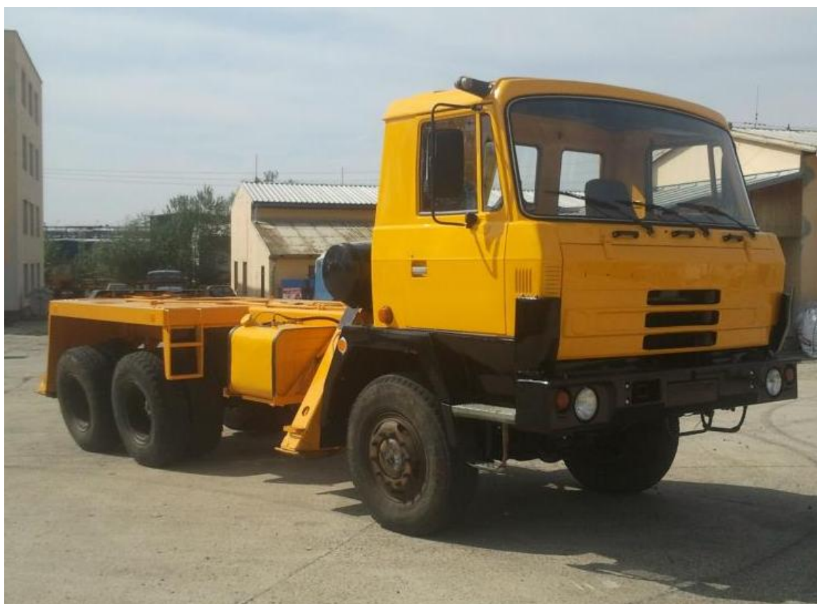
Obr. 19 - Podvozek Tatra 815 P17 se spodním rámem UDS [9]
