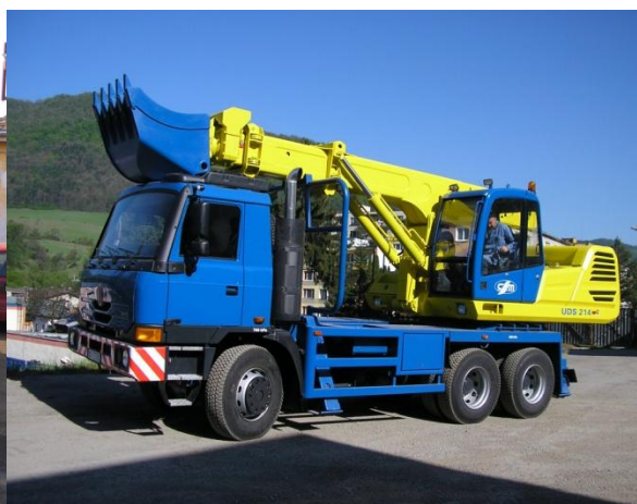
Obr. 7 - Rypadlo s teleskopickým výložníkem na automobilovém podvozku [4]
