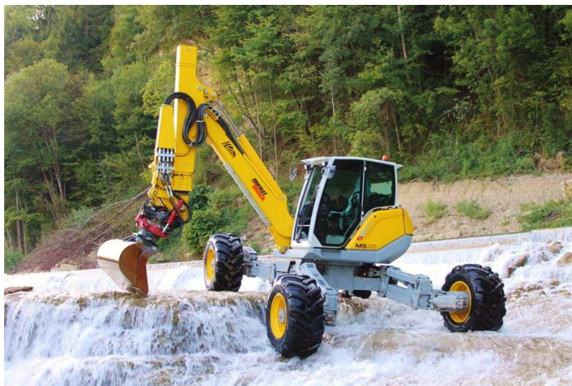
Obr. 8 - Rypadlo s kráčivým podvozkom [24]
