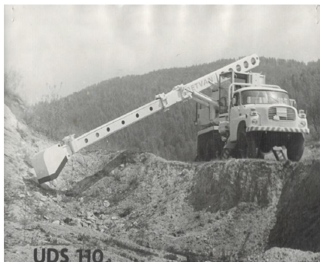
Obr. 22 - Teleskopické rypadlo UDS 110 na podvozku Tatra 148 [4]
