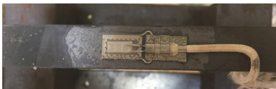
Obr. 6.10: Extenzometr P5 (MM-Vishay) detail přivaření
