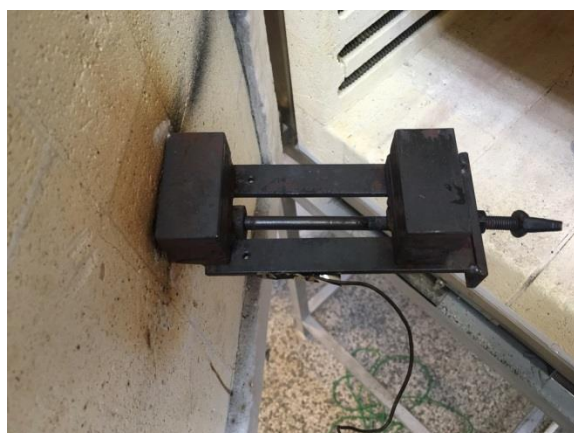
Obr. 6.16: Kalibrační přípravek (vnitřní část)
