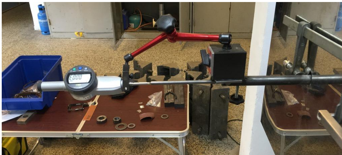
Obr. 6.15: Kalibrační přípravek (vnější část) a digitální úchylkoměr
