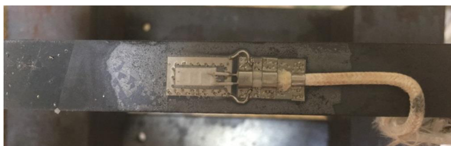
Obr. 6.10: Extenzometr P5 (MM-Vishay) detail přivaření
