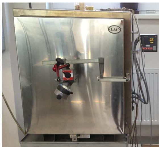
Obr. 6.13: Pec LAC-L70S a regulátor HTH200
