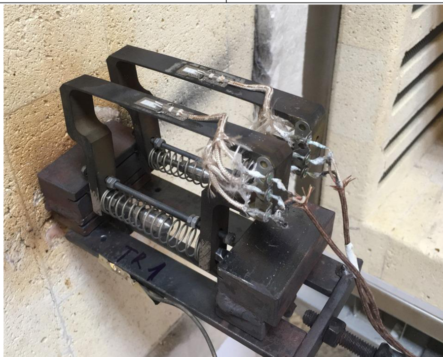
Obr. 6.9: Extenzometr P5 (MM-Vishay) umístěná v experimentálním zařízení (v peci)
