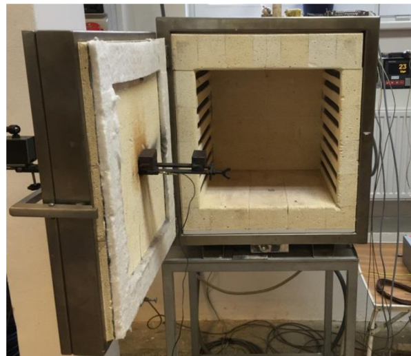
Obr. 6.13: Pec LAC-L70S a regulátor HTH200
