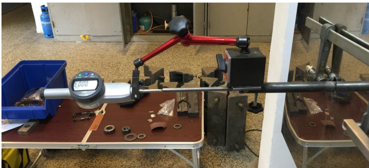
Obr. 6.15: Kalibrační přípravek (vnější část) a digitální úchylkoměr
