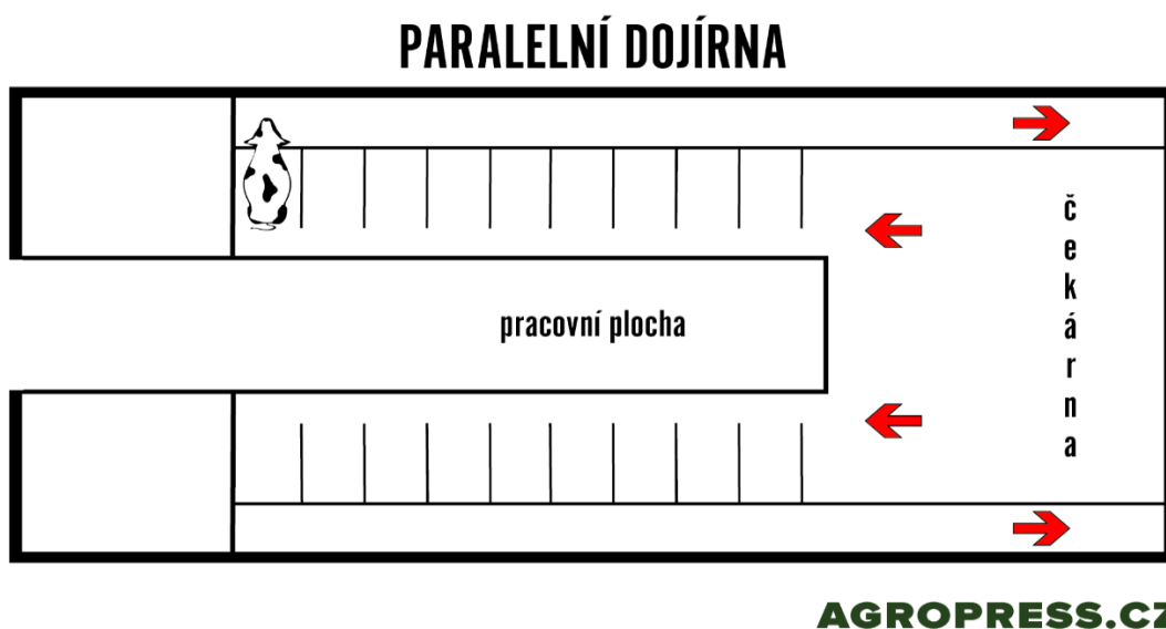
Obr. č. 4 - Paralelní dojírna. Zdroj: Agropress.cz, 2017
