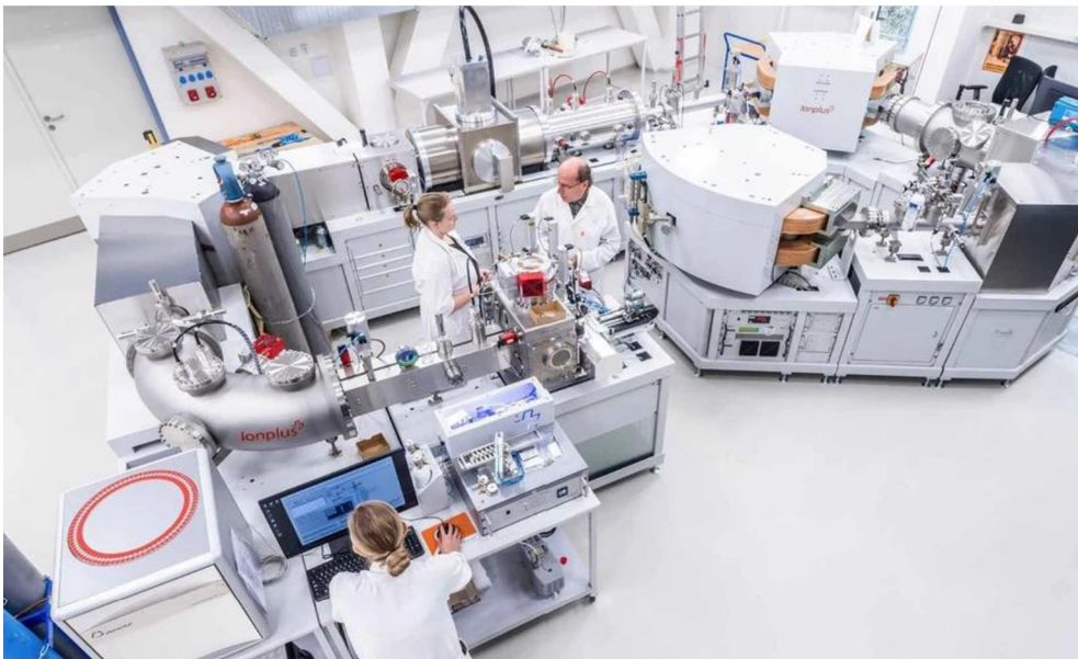
Obrázok 7: Urýchľovač hmotnostnej spektrometrie MILEA v Ústave jadrovej fyziky AV ČR v Řeži
