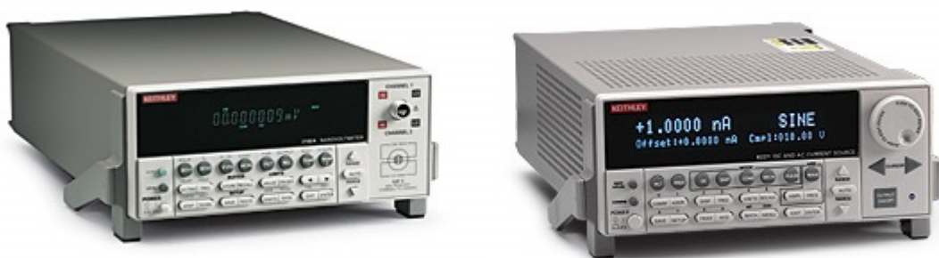
Obrázek 5.5: Nanovoltmetr Keithley 2182a (vlevo) a proudový zdroj Keithley 6221 (vpravo) použité k měření voltampérové charakteristiky solárního článku.
