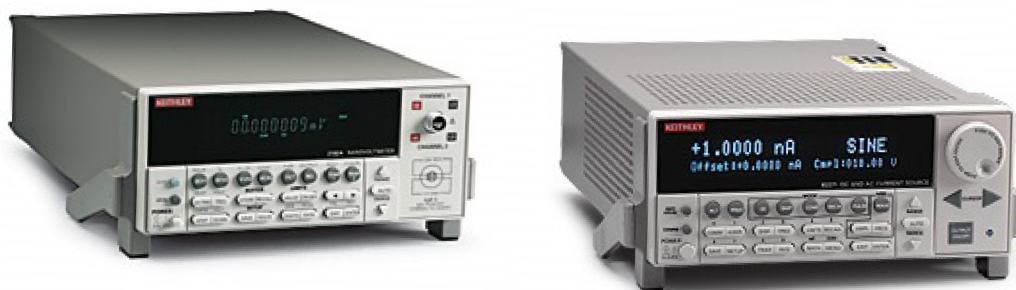
Obrázek 5.5: Nanovoltmetr Keithley 2182a (vlevo) a proudový zdroj Keithley 6221 (vpravo) použité k měření voltampérové charakteristiky solárního článku.
