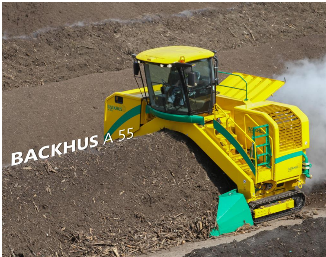
Obr. 11 Samojízdný překopávač A 55 od firmy BACKHUS GmbH
