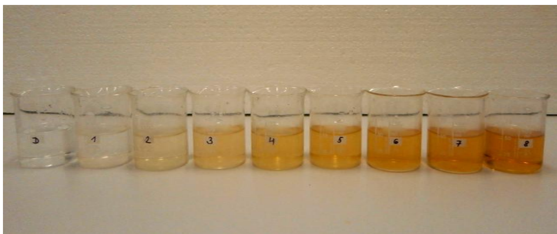
Obr. 2: Vybarvená kalibrační řada po uplynutí reakční doby roztoků.
