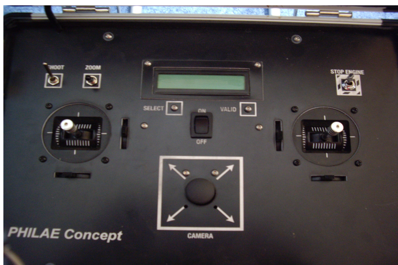
Obr. 13 Rozložení ovládacích prvků na pozemní stanici.
