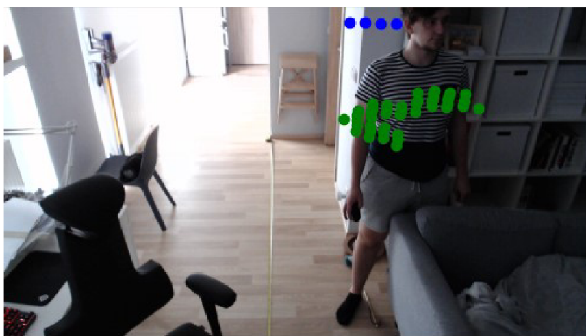
Obrázek 4.10: Vstupní obrázek z kamery obohacený o body radaru rozdělených do shluků
