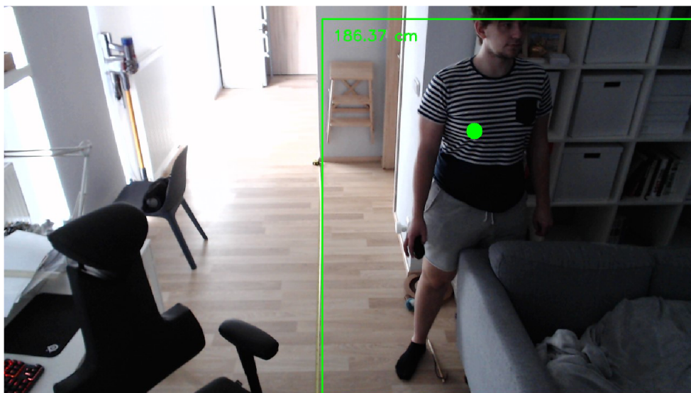
Obrázek 4.11: Vstupní obrázek z kamery obohacený o rámeček značící přítomnost osoby a její vzdálenost
