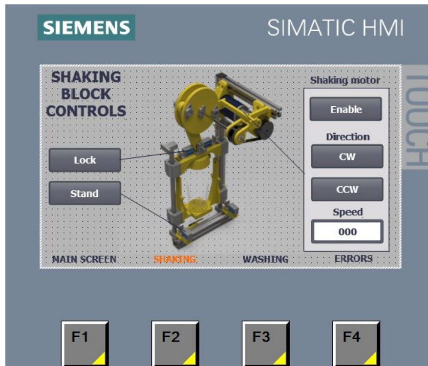
Obr. 7.9: Obrazovka ovládání funkčního celku protřepání nápoje
