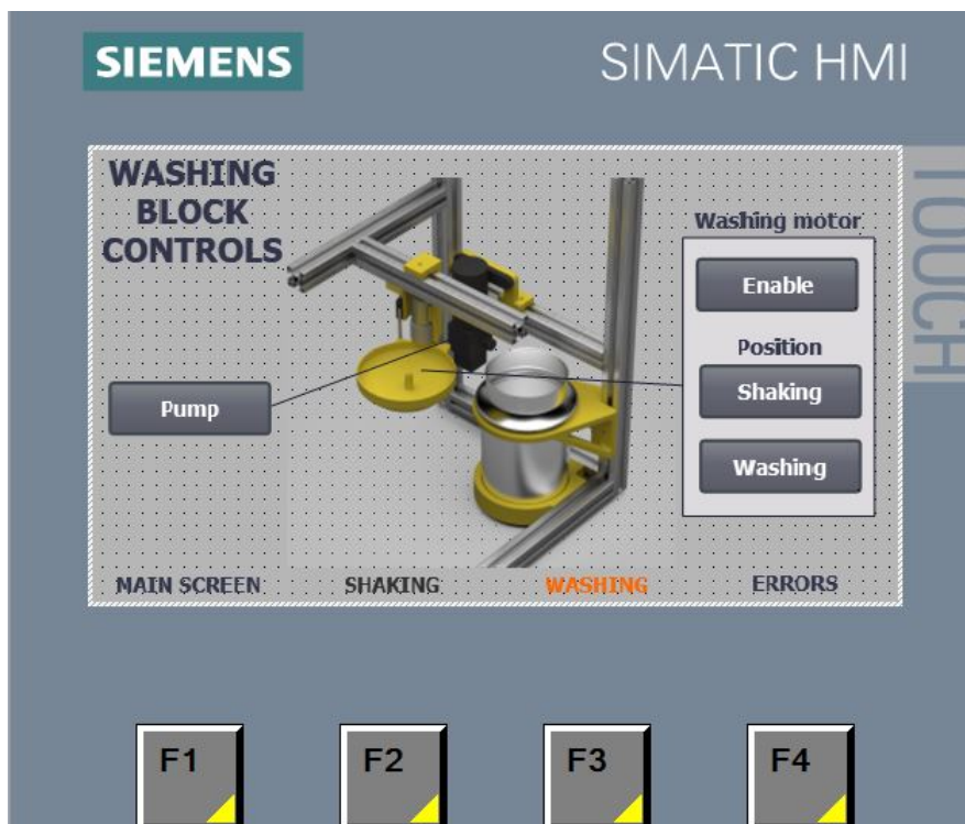
Obr. 7.10: Obrazovka ovládání funkčního celku omytí
