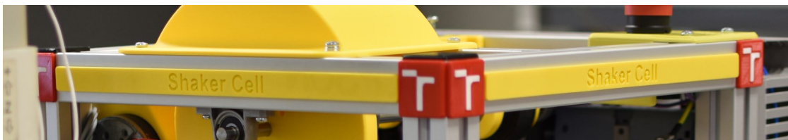
Obr. 3.3: Identifikační prvky pro rozšířenou realitu
