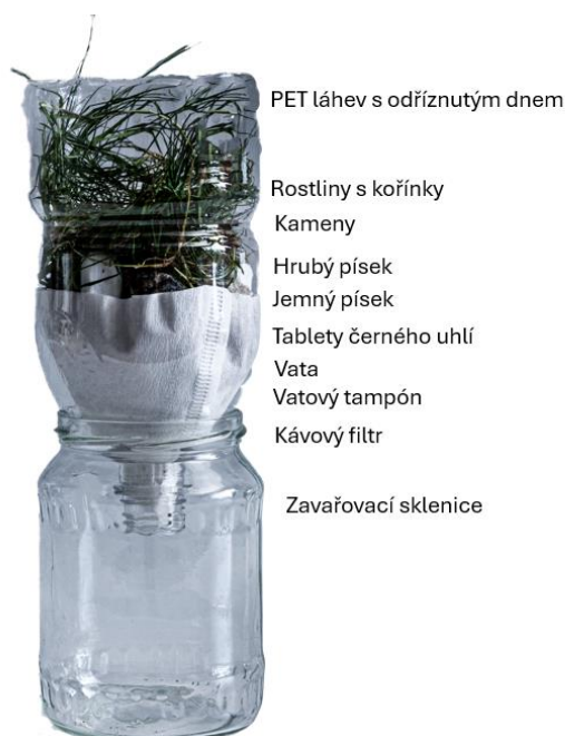
Obrázek 36: Fotografie reálné aparatury modelu kořenové čistírny
