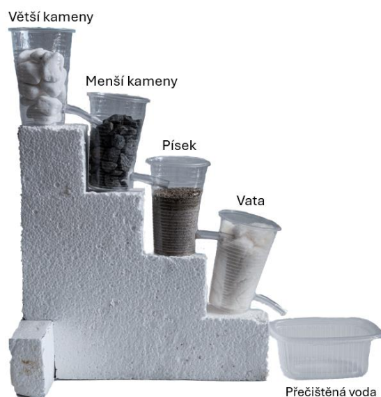
Obrázek 37: Fotografie reálné aparatury – model vícestupňového filtru
