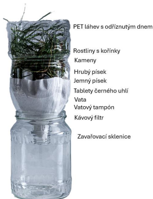
Obrázek 36: Fotografie reálné aparatury modelu kořenové čistírny
