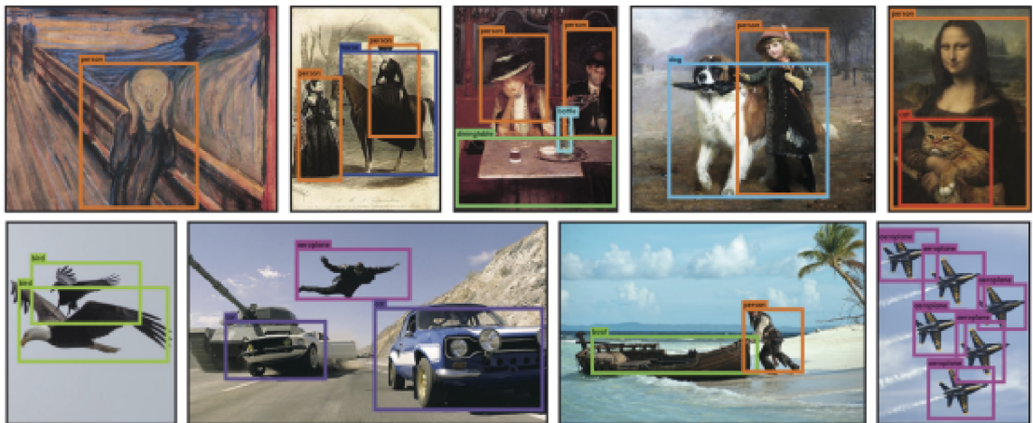
Obr. 3.4: Príkladné využitie YOLO detekcie na rôznych objektoch. I keď je to väčšinou presné, ale i tak sa nájdu výnimky ako napríklad detekcia osoby ako lietadlo, prevzaté z [45].
