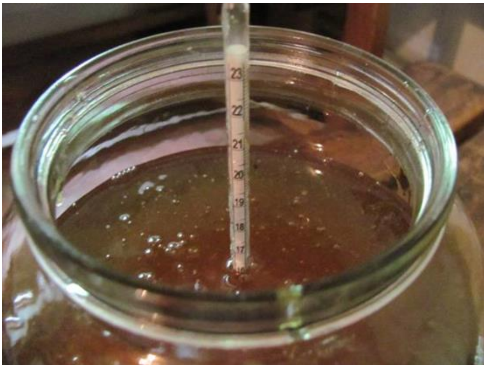
Obr. č. 16 – Ponořený hustoměr do čerstvě vytočeného medu; hodnota obsahu vody je 16,2 % (Foto: Eva Kopřivová)
