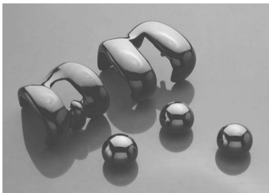
obr. 2-11 DLC povlak na kolenní protéze (vlevo) a femorální hlavici (vpravo) [20]
