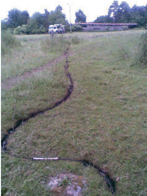
Obr. 4. Utržený vodič VN v dotyku se zemí
