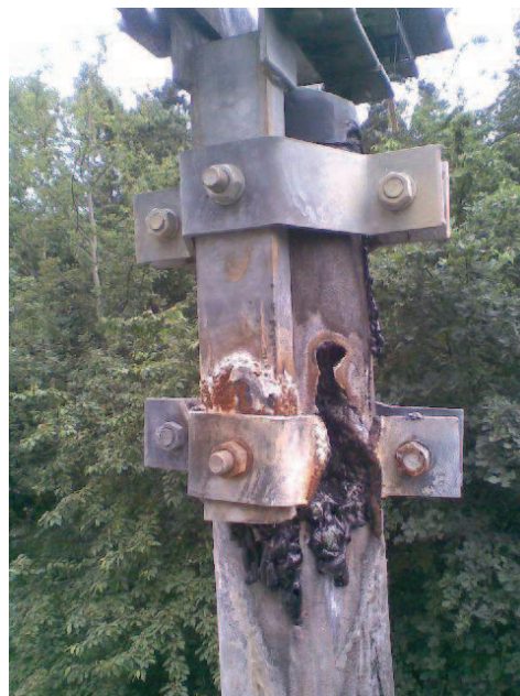
Obr. 2. Přetržení úchyty lana, důsledky zemního spojení přes konzolu a sloup
