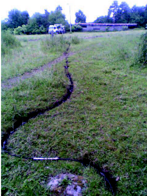
Obr. 4. Utržený vodič VN v dotyku se zemí
