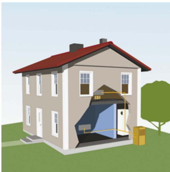
Obrázek 10 Tepelného čerpadla vzduch – voda [3.]
