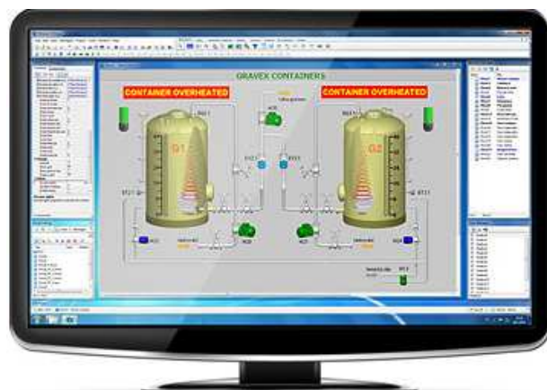
Obr. 23 Ukázka SCADA systému Reliance
