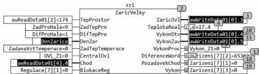
Obr. 44 Instance funkčního bloku pro velký zářič
