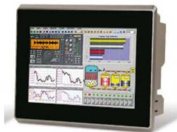
Obr. 12 Řídicí a regulační jednotka na bázi PC společnosti DOMAT Zdroj: http://domat-int.com/wp-content/uploads/KL/CZ/domat_IPCT.1_cz.pdf
