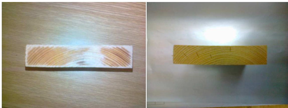
Obr. 6 Změna struktury smrkového vzorku vlivem vlhkosti.
