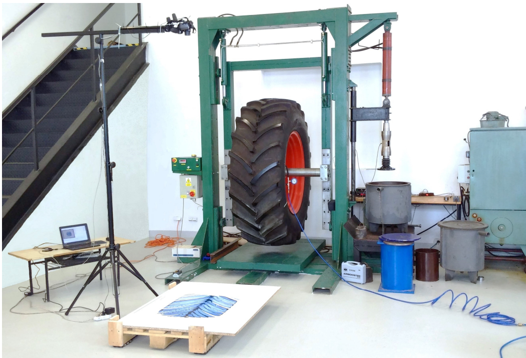
Obrázek 15 Laboratorní zařízení s testovanou pneumatikou Mitas 650/65R38 doplněné vybavením pro digitální záznam otisků a sadou pro regulaci tlaku huštění pneumatiky
