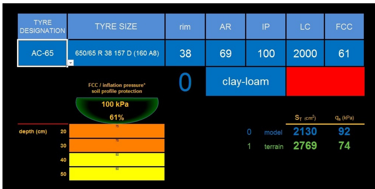
Obrázek 20 Příklad stanovení indexu FCC pneumatiky Mitas 650/65 R38 RD-03 pro standardizovanou jílovito-hlinitou půdu při provozním zatížení 2000 kg a tlaku huštění 100 kPa
