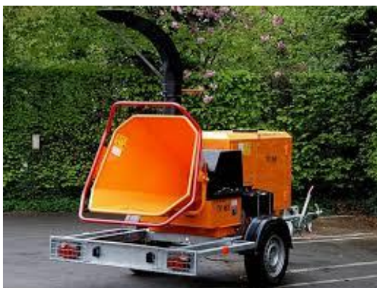
Obrázek 12: Tažený štěpkovač s vlastní pohonnou jednotkou (zdroj:www.google.cz online 2015)
