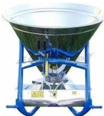
Obrázek 11: Nesené rozmetadlo hnojiv s nerezovým zásobníkem (zdroj: autor)
