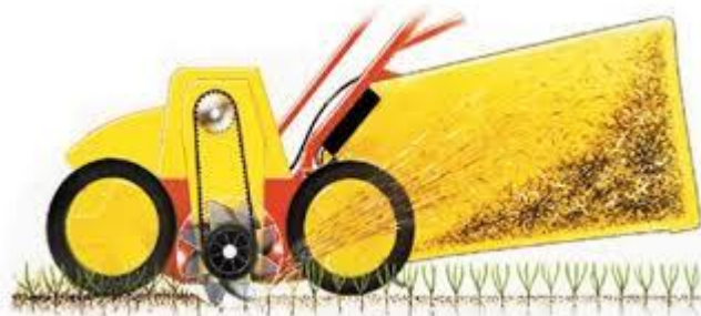
Obrázek 2: Princip činnosti vertikutátoru (zdroj: google,online 2015)
