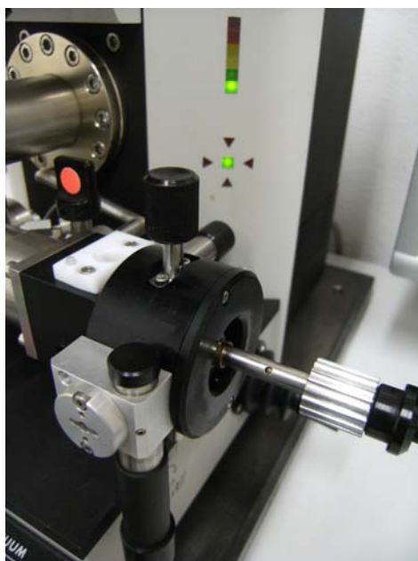
Obr.5. Držák preparátu a komora preparátu nízkonapětového elektronového mikroskopu LVTEM 5
