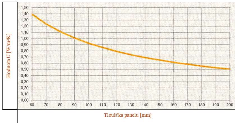
Graf 3 – Grafická metoda posouzení koeficientu prostupu tepla k tloušťce CLT panelu 113
