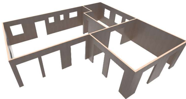
Obrázek 15 - Schéma stěnové prefabrikované konstrukce objektu 118
