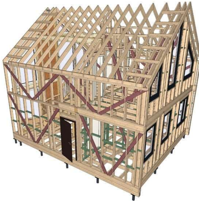
Obrázek 6 – Návrh konstrukce rámové dřevostavby 26
