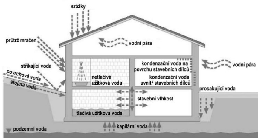
Obrázek 13 – Typická zatížení budov vlivem vlhkosti 116
