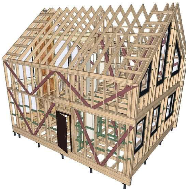
Obrázek 6 – Návrh konstrukce rámové dřevostavby 26
