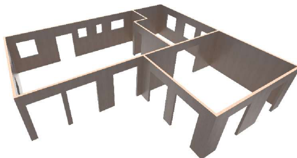
Obrázek 15 - Schéma stěnové prefabrikované konstrukce objektu 118
