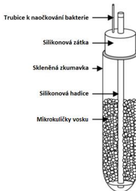
Obrázek 11: Schéma aparatury pro výrobu porézní bakteriální celulózy [24]
