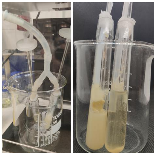
Obrázek 19: Aparatura pro kultivaci BC ve zkumavkách připojených ke vzduchu
