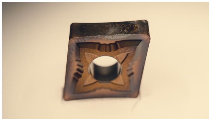
Obr. 6.7 Pozorovaná břitová destička s viditelným tepelným ovlivněním hřbetu.
