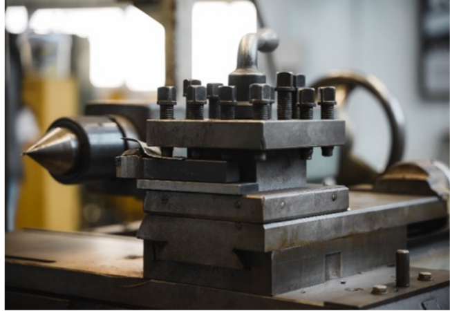
Obr. 1.6 Otočná nožová hlava.
