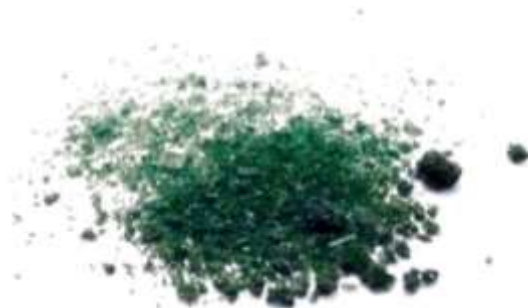
Obr. 15: Nasyntetizovaný donor NO ze skupiny S-nitrosothiolů (SNAPs,) určený k modifikaci PCL vláknenných vrstev, vyhotovených elektrostatickým zvlákňováním. Přesným dodržáním postupu syntézy SNAPs (viz výše) dochází ke vzniku charakteristické krystalické struktury temně zelené barvy.
