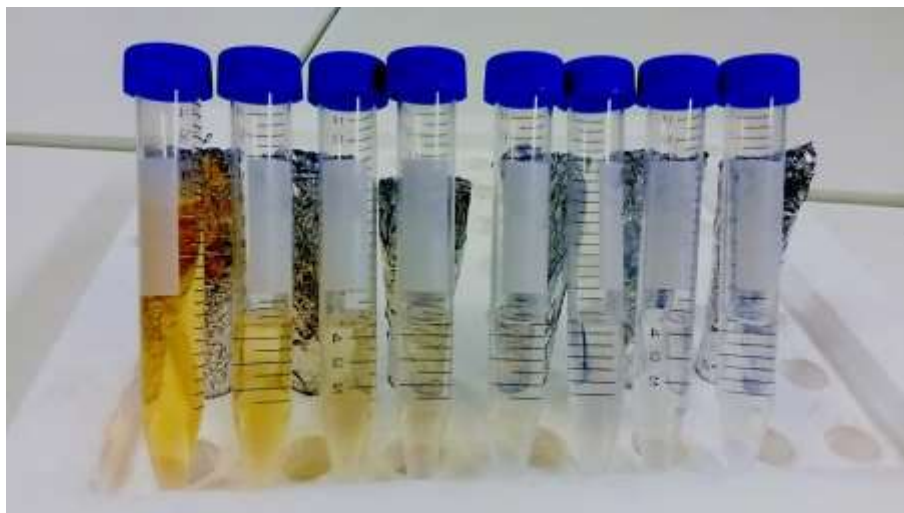
Obr. 17: Kalibrační řada roztoků dusitanu sodného ( \text{NaNO}_2 ) +SA +NEDD pro tvorbu kalibračních křivek, pro vyhodnocení množství uvolněného NO z testovaných vzorků. Molární koncentrace roztoků \text{NaNO}_2 (zleva): 1,445 mM, 722.5, 361.25, 180.625, 90.313, 45.156, 22.578, 11.289 \mu\text{M} .
