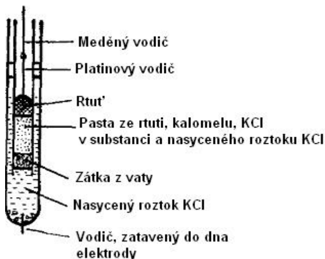
obr. č.1.2 Jeden z typů kalomelové elektrody [3]
