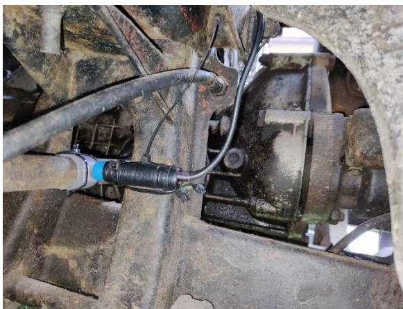
Obrázek 28: upevnění držáků a snímače k automobilu
