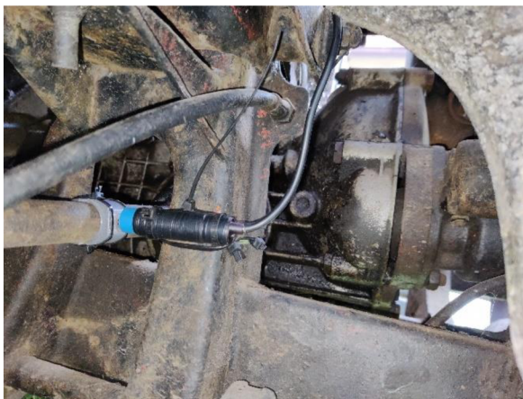
Obrázek 28: upevnění držáků a snímače k automobilu
