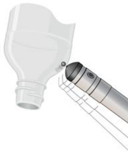
Obrázek č. 9: Měření tloušťky stěn láhve tloušťkoměrem pomocí Hallova efektu (www.mega-nk.ru)
