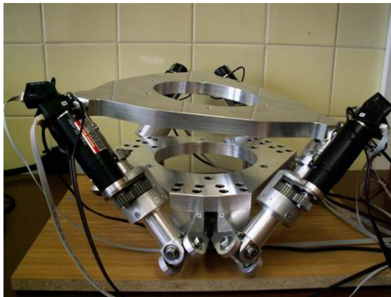
Obr.6 Stewartova platforma zkonstruovaná na Fakultě strojního inženýrství.
