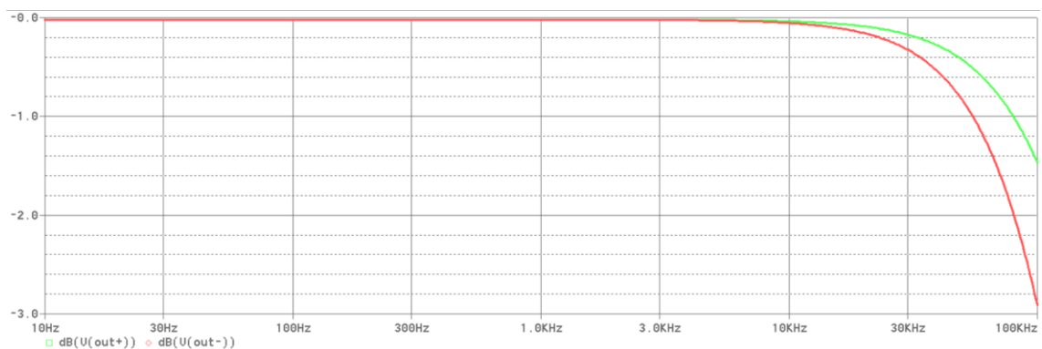
Obrázok 2.18 Kmitočtová charakteristika výstupu zariadenia
