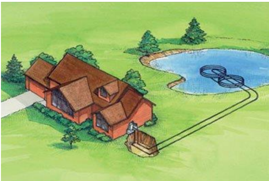
Obr. 10 - Odebírání tepla ze stojaté vody [9]
