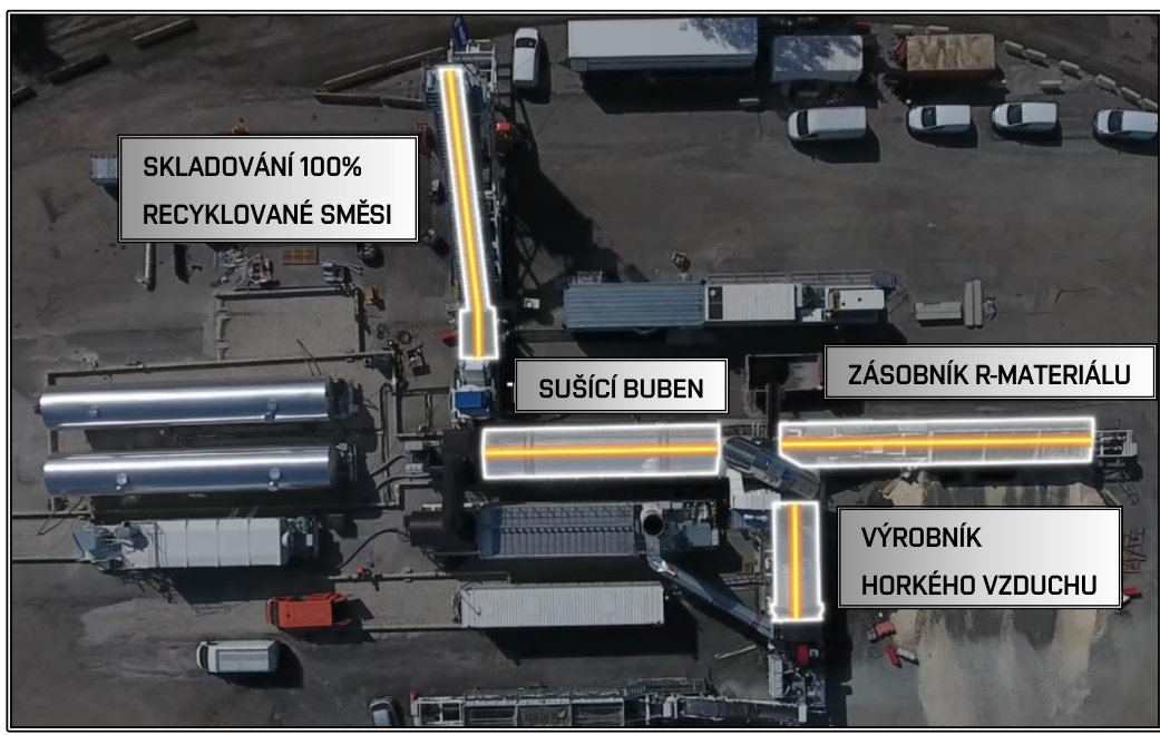
Obrázek č. 5: Kontinuální obalovna na výrobu asfaltové směsi se 100 % R-materiálu [7]
