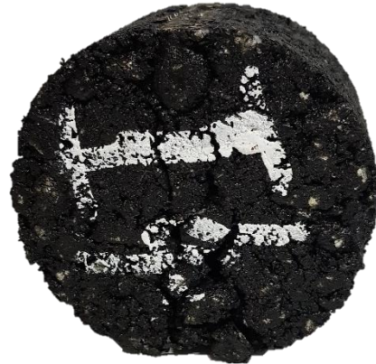
Obrázek č. 17: Detail porušeného tělesa ze směsi DP 35 po zkoušce v příčném tahu
