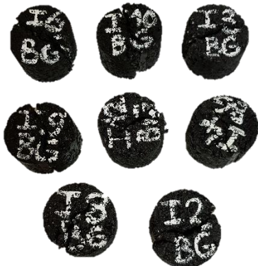
Obrázek č. 16: Porušená zkušební tělesa směsi DP 35 BG po zkoušce v příčném tahu
