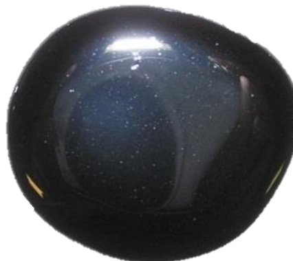
Obrázek č. 11: Asfalt 70/100
