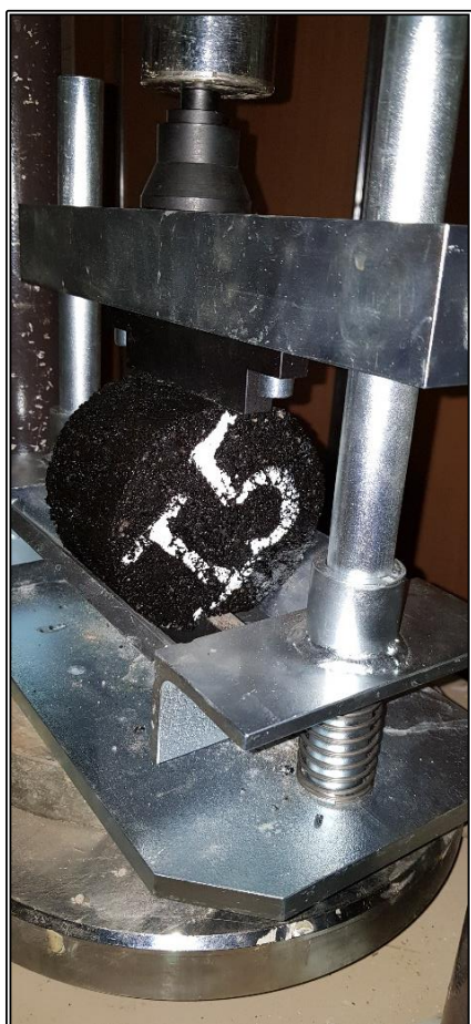
Obrázek č. 15: Těleso v lisu před zkouškou v příčném tahu ITSR
