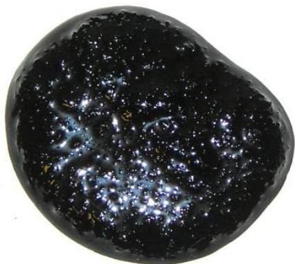
Obrázek č. 10: Asfalt 70/100 CRMB
