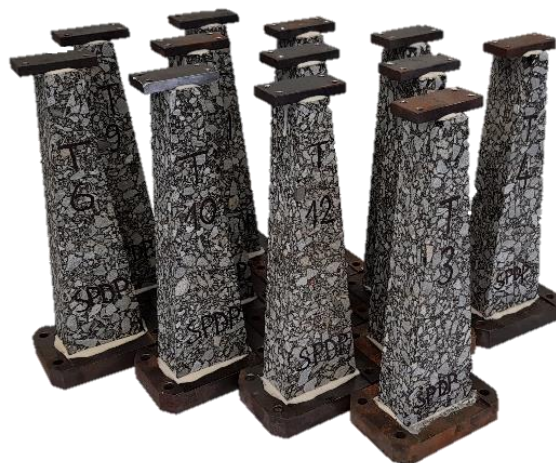
Obrázek č. 23: Zkušební tělesa pro zkoušky modulů a únavy
