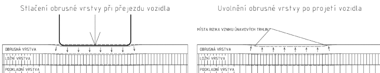
Obrázek č. 24: Schéma únavového namáhání obrusné vrstvy
