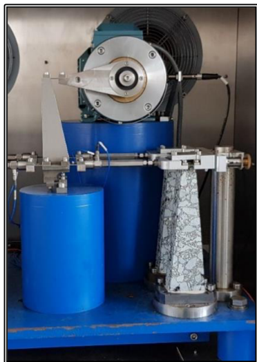
Obrázek č. 22: Zkušební trapezoid v temperační komoře
