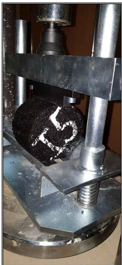
Obrázek č. 15: Těleso v lisu před zkouškou v příčném tahu ITSR
