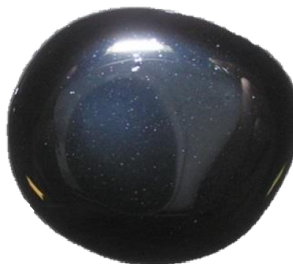
Obrázek č. 11: Asfalt 70/100
