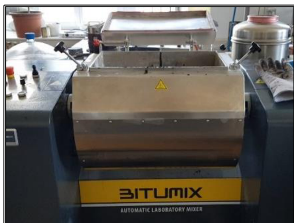
Obrázek č. 26: Míchačka asfaltových směsí
