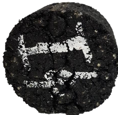
Obrázek č. 17: Detail porušeného tělesa ze směsi DP 35 po zkoušce v příčném tahu
