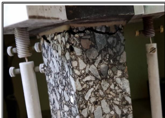
Obrázek č. 20: Detail porušení trámce
