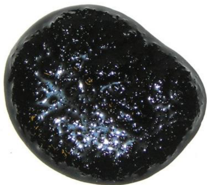
Obrázek č. 10: Asfalt 70/100 CRMB
