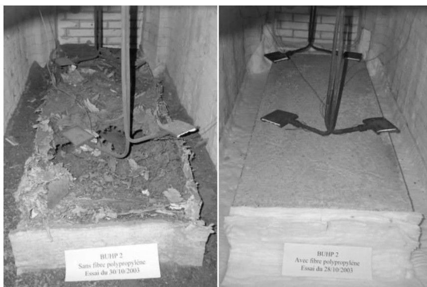
Obrázek 9 - Desky z UHPFRC, vlevo bez PP vláken, vpravo s PP vlákny [66]
