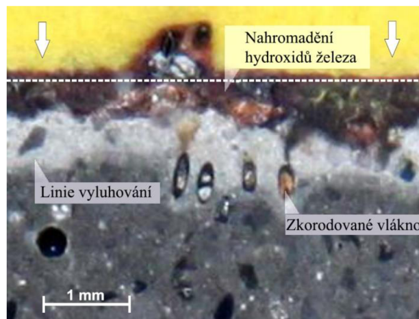
Obrázek 8 - Řez UHPC po 80 týdnech chemického napadení [70]
