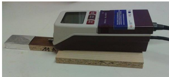
Obr. 18. Drsnomer (zdroj: vlastný)
