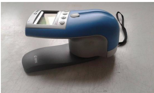
Obr. 20. Spektrofotometer (zdroj: vlastný)
