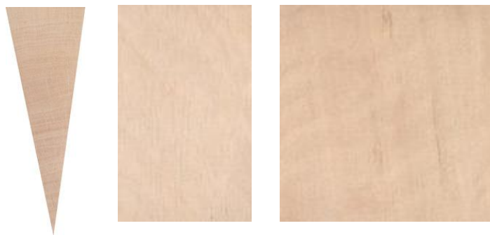
Obr. 12.,13.,14. Priečny, radiálny a tangenciálny rez dreva jelši (zdroj: http://ldf.mendelu.cz/ )
