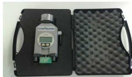
Obr. 19. Mikrotvrdomer (zdroj: vlastný)
