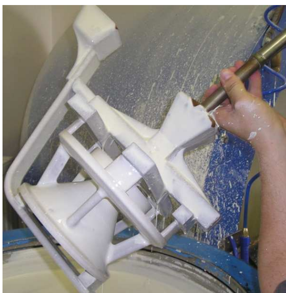
obr. 38 Namáčení (vlevo), okapání (vpravo)
