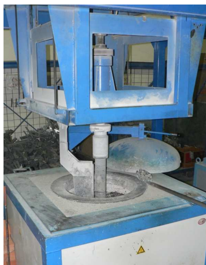
obr. 43 Odplyňovací jednotka FDU
