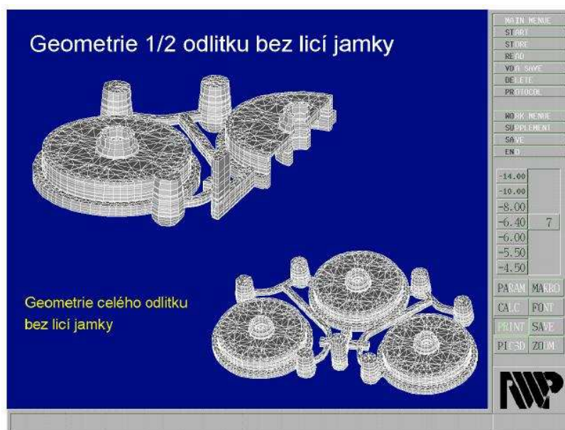
obr. 25 Geometrie, síť CAD a rozmístění součástí ve formě včetně umístění vtokové soustavy bez licí jamky [9]
