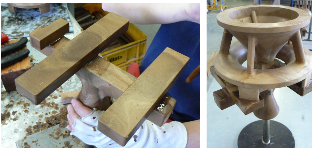
obr. 34 Sestavení vtokové soustavy „a“
