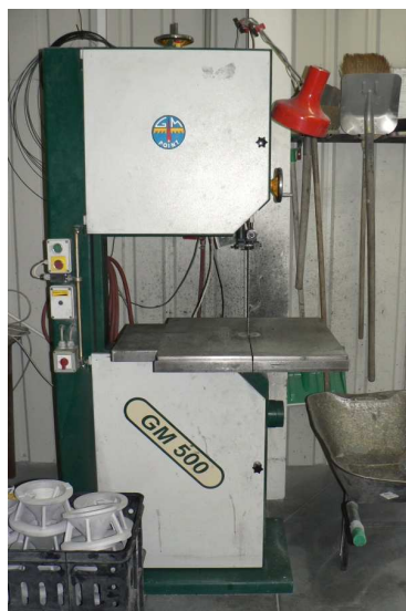
obr. 51 Pásová pila na odřezání vtoků (vlevo), tryskávací jednotka OTECO (vpravo)
