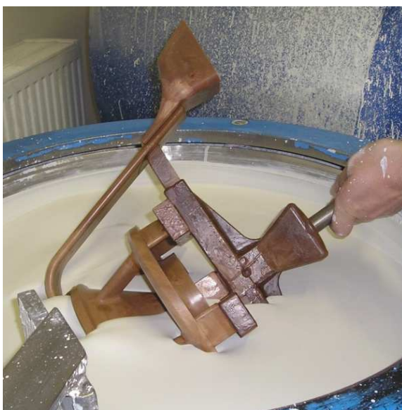
obr. 38 Namáčení (vlevo), okapání (vpravo)
