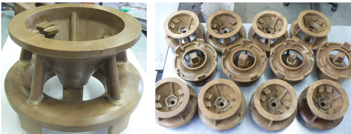
obr. 33 Hotový voskový model (bez vtokové soustavy)
