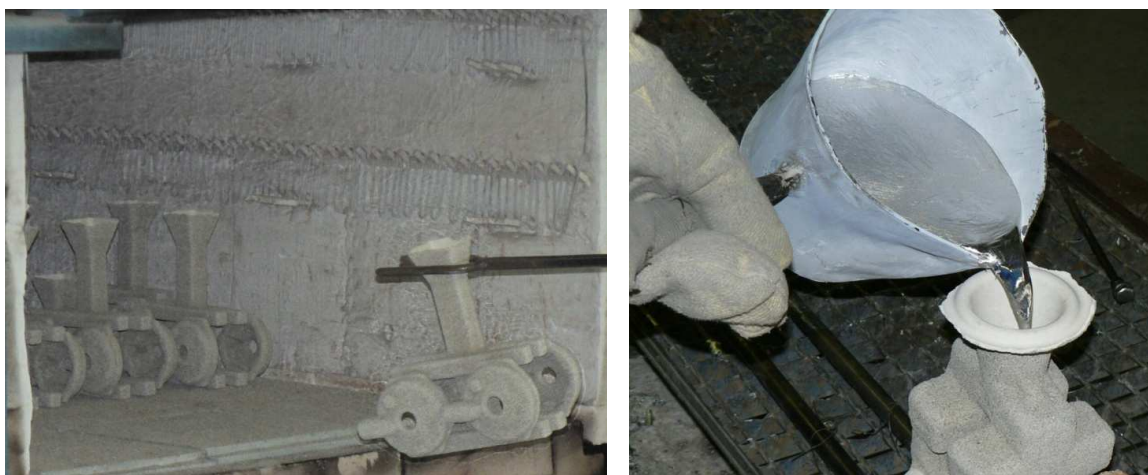
obr. 11 Vytahování vypálené skořepiny (vlevo), odlévání (vpravo)
