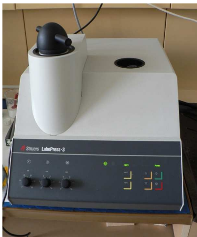
obr. 71 LaboPress-3 firmy STRUERS (vlevo), zalité vzorky (vpravo)
