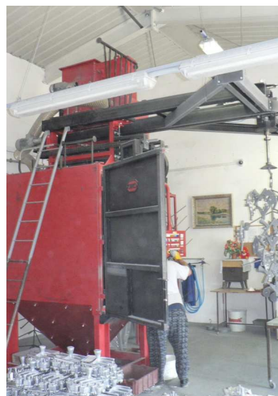
obr. 51 Pásová pila na odřezání vtoků (vlevo), tryskávací jednotka OTECO (vpravo)
