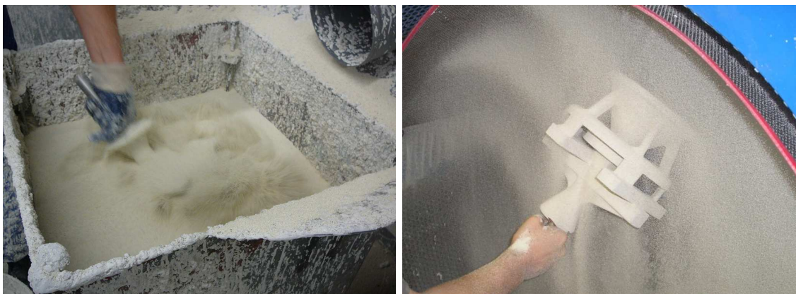
obr. 9 Fluidní posyp (vlevo) , gravitační posyp (vpravo)
