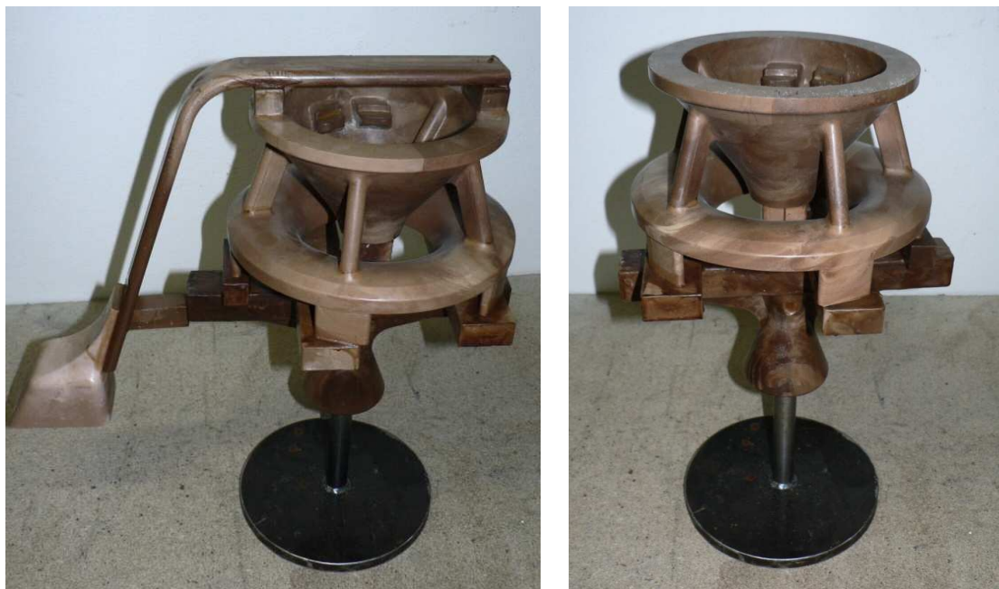
obr. 36 Hotová vtoková soustava „a“ (vlevo) i „b“ (vpravo)
