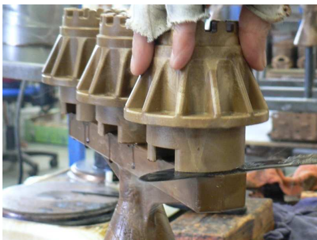
obr. 7 Pájení voskových modelů na stromeček
