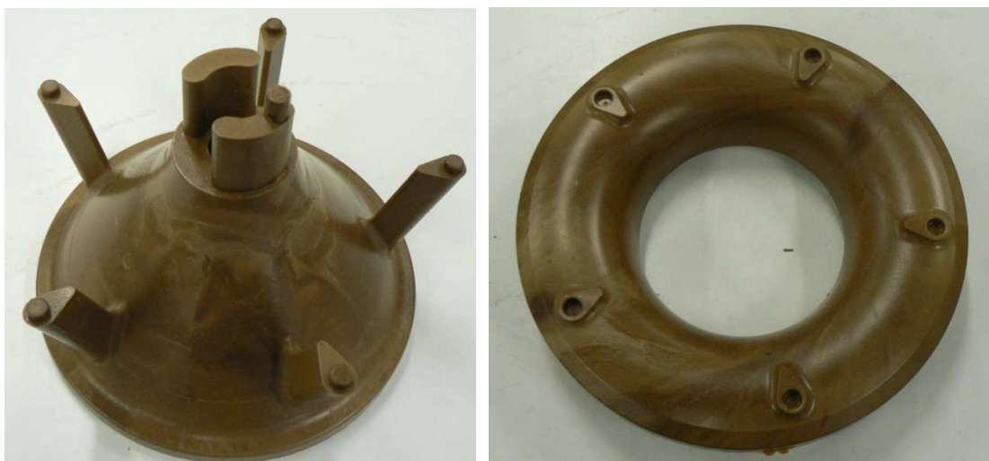
obr. 30 Vyjmutý voskový model „X“ (vlevo), vyjmutý voskový model „Y“ (vpravo)
