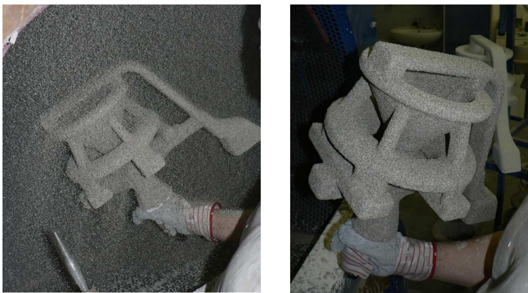
obr. 41 Posyp stromečku (vlevo), hotový čtvrtý obal (vpravo)
