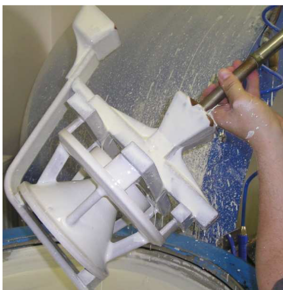
obr. 38 Namáčení (vlevo), okapání (vpravo)
