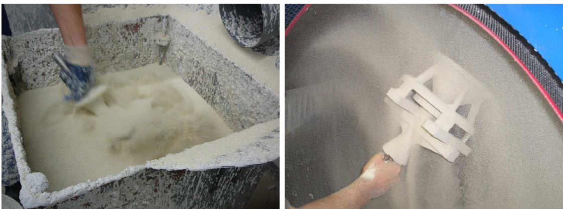
obr. 9 Fluidní posyp (vlevo) , gravitační posyp (vpravo)
