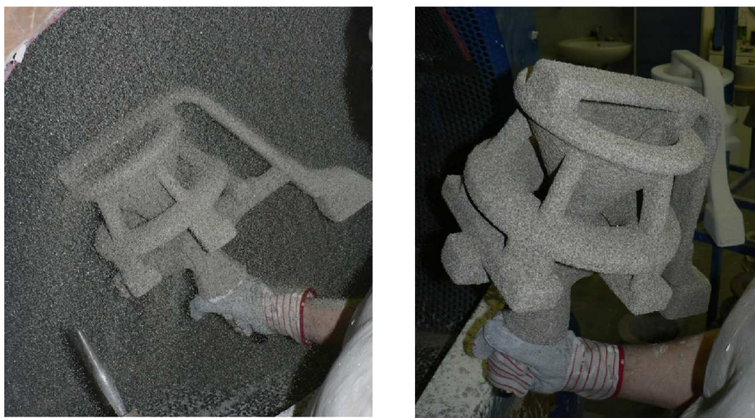
obr. 41 Posyp stromečku (vlevo), hotový čtvrtý obal (vpravo)
