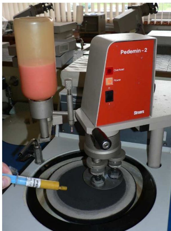
obr. 72 Vybroušení, zařízení DAP – 7 firmy STRUERS (vlevo), leštění s diamantovou pastou (vpravo)
