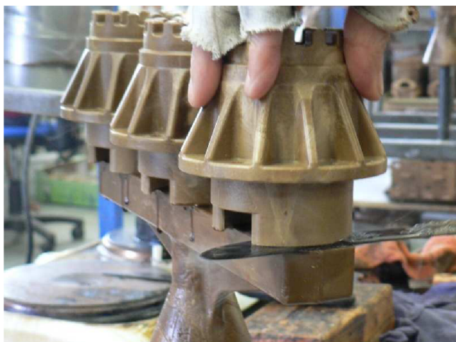
obr. 7 Pájení voskových modelů na stromeček
