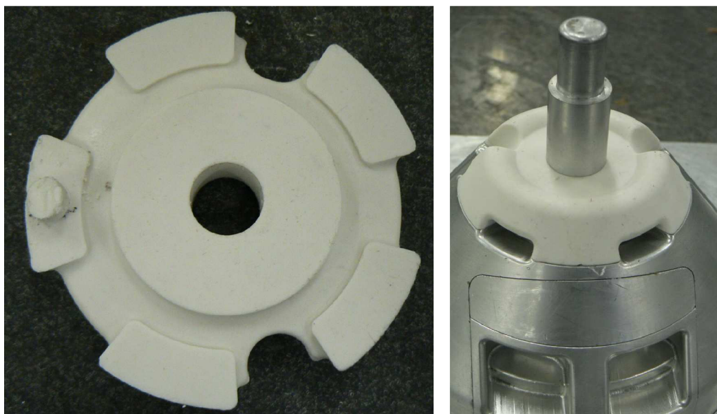
obr. 28 Voskové jádro (vlevo) a jeho umístění ve formě (vpravo)
