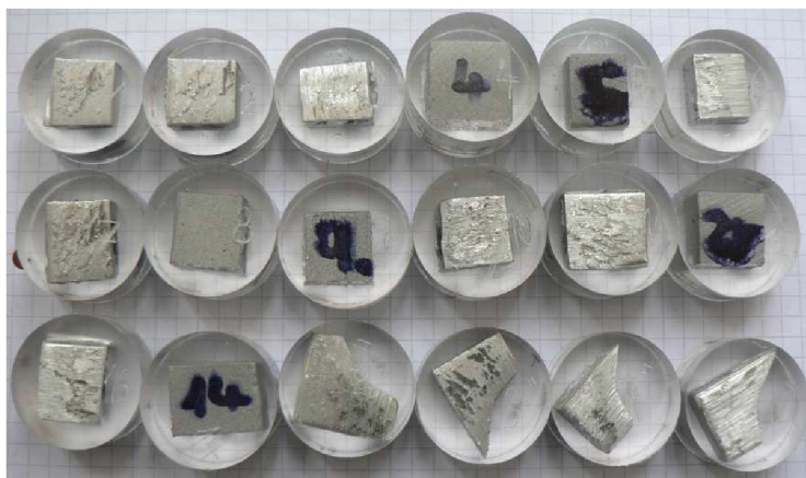
obr. 71 LaboPress-3 firmy STRUERS (vlevo), zalité vzorky (vpravo)
