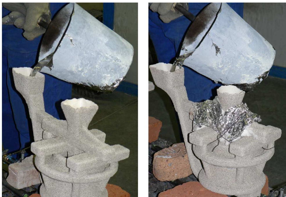
obr. 50 Odlévání varianty „B“ (vlevo) a „B+“ (vpravo)
