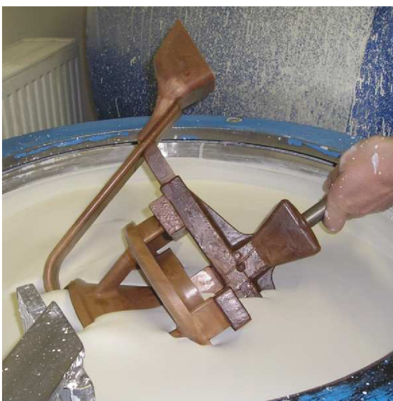
obr. 38 Namáčení (vlevo), okapání (vpravo)
