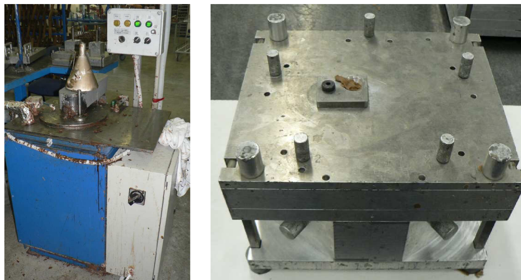
obr. 29 Plnička vosku (vlevo), naplněná matečná forma „X“ (vpravo)
