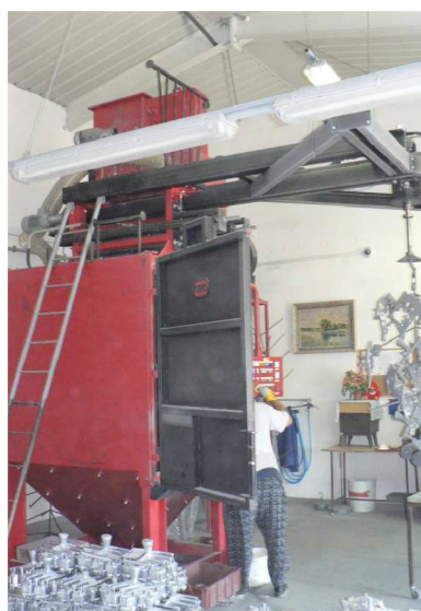
obr. 51 Pásová pila na odřezání vtoků (vlevo), tryskací jednotka OTECO (vpravo)
