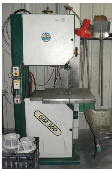
obr. 51 Pásová pila na odřezání vtoků (vlevo), tryskací jednotka OTECO (vpravo)
