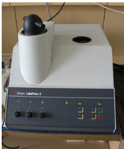
obr. 71 LaboPress-3 firmy STRUERS (vlevo), zalité vzorky (vpravo)
