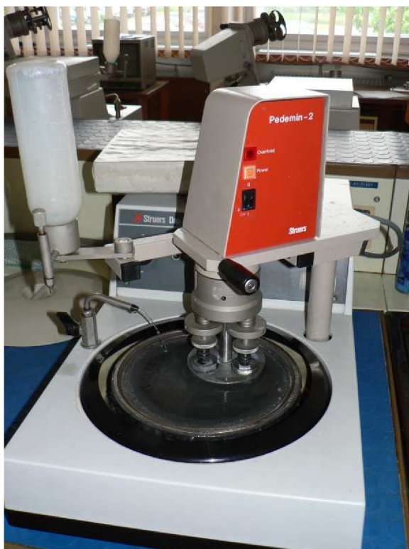
obr. 72 Vybroušení, zařízení DAP – 7 firmy STRUERS (vlevo), leštění s diamantovou pastou (vpravo)
