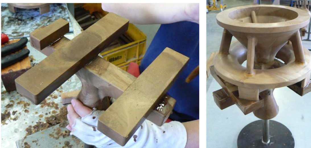
obr. 34 Sestavení vtokové soustavy „a“
