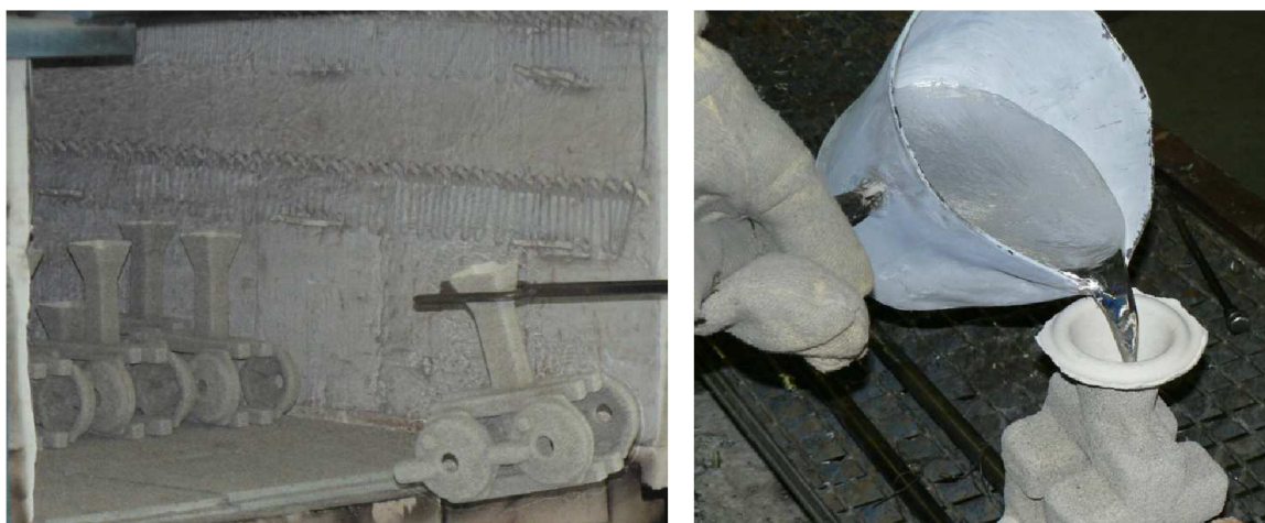
obr. 11 Vytahování vypálené skořepiny (vlevo), odlévání (vpravo)
