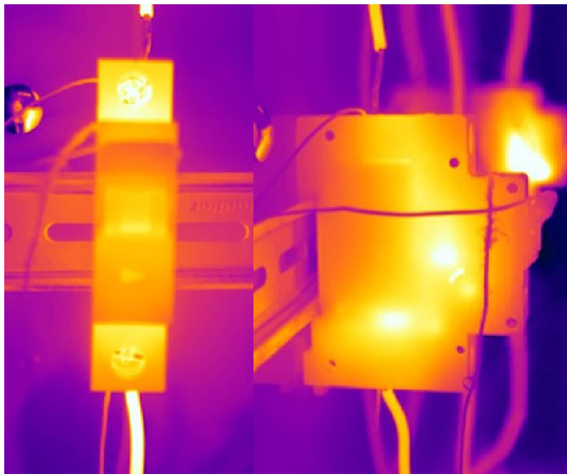
Obr. 8-3 Snímky z termokamery jističe 1
