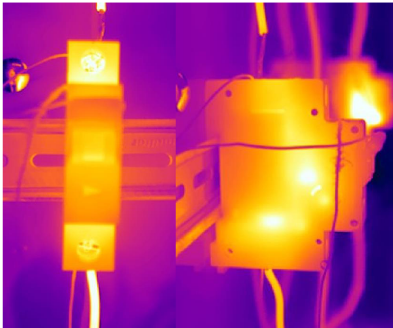
Obr. 8-3 Snímky z termokamery jističe 1
