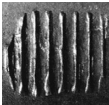
Obr. č. 32 - statická stopa (vtisk kleští) zdroj: Charvát Adam, Kriminalistická mechanoskopie, vývoj a zkoumání cylindrických vložek, 2021 [online]. [cit. 2024-01-25]. Dostupné z: https://bakalarky.vsers.cz/2021/kombinovan%C3%A9/BEPR%C4%8C/Charv%C3%A1t%20Adam/
