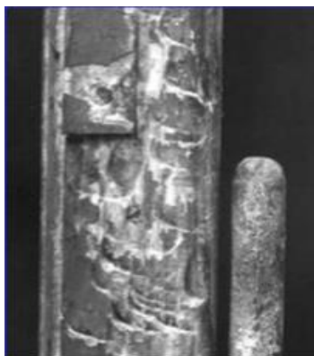
Obr. č. 34 - dynamická stopa zhmožděná zdroj: Charvát Adam, Kriminální mechanoskopie, vývoj a zkoumání cylindrických vložek, 2021 [online]. [cit. 2024-01-25]. Dostupné z: https://bakalarky.vsers.cz/2021/kombinovan%C3%A9/BEPR%C4%8C/Charv%C3%A1t%20Adam/bpc_ks_c_harvat_adam.pdf
