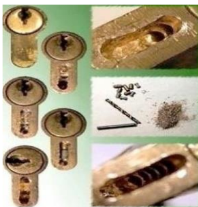
Obr. č. 22 - odvrtaný stavítkový kanál
