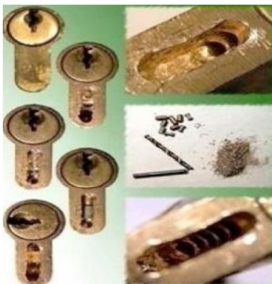
Obr. č. 22 - odvrtaný stavítkový kanál
