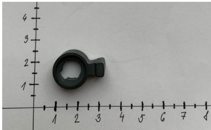
Obr. č. 6 zub cylindrické vložky zdroj: vlastní zpracování
