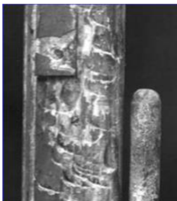
Obr. č. 34 - dynamická stopa zhmožděná zdroj: Charvát Adam, Kriminální mechanoskopie, vývoj a zkoumání cylindrických vložek, 2021 [online]. [cit. 2024-01-25]. Dostupné z: https://bakalarky.vsers.cz/2021/kombinovan%C3%A9/BEPR%C4%8C/Charv%C3%A1t%20Adam/bpc_ks_charvat_adam.pdf
