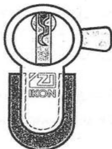
Obr. č. 18b zábrana ve tvaru „U“ zdroj: Machytka Václav, Vývoj cylindrických vložek, 2020 [online]. [cit. 2024-02-02]. Dostupné z: https://is.ambis.cz/th/cc7c8/Bakalarska_prace_Vaclav_
