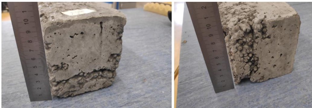
Obr. 22: Zkušební tělesa ze samozhutnitelného betonu
