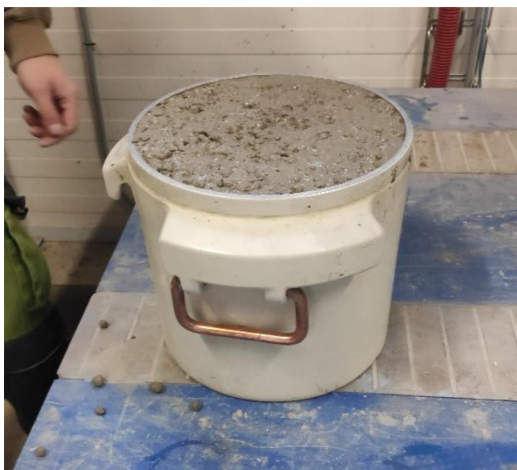
Obr. 36: Stanovené objemové hmotnosti čerstvého betonu
