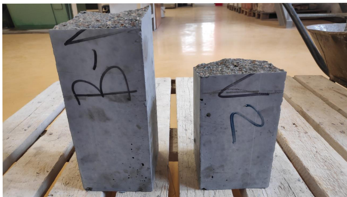
Obr. 39: Předpokládané porušení zkušebního hranolu v tahu ohybem
