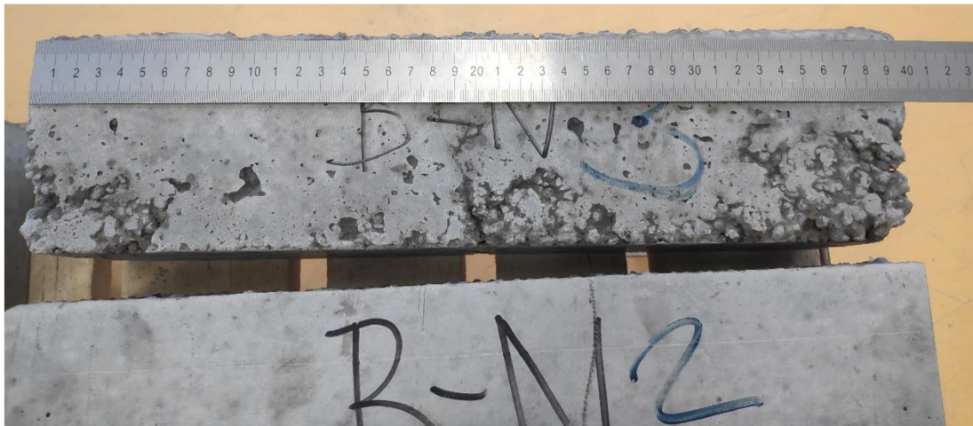
Obr. 43: Kaverny na zkušebním hranolu B-N3
