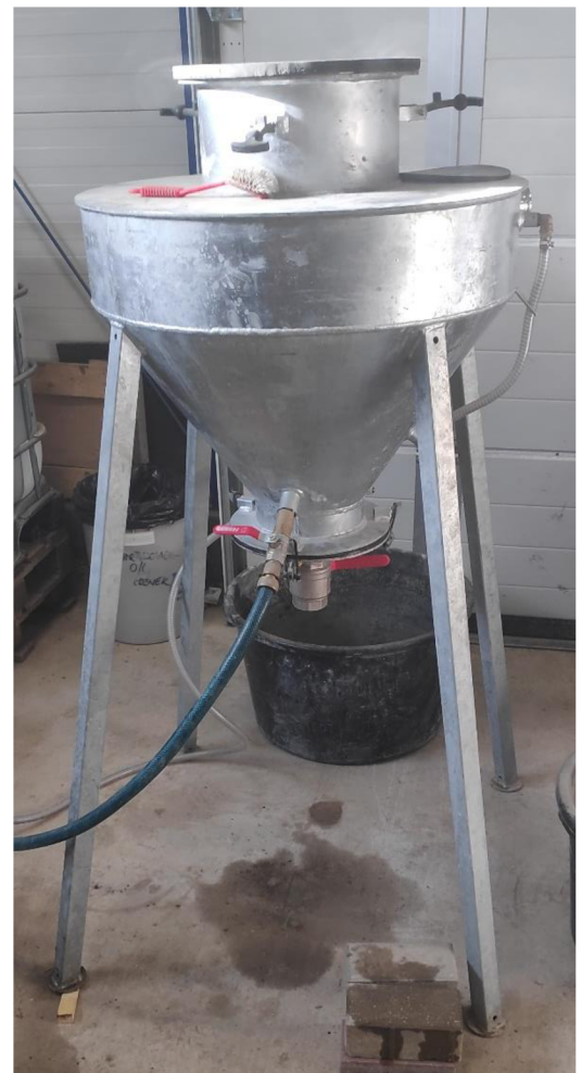
Obr. 37: Trychtýř pro urychlení namáčení lehkého umělého kameniva
