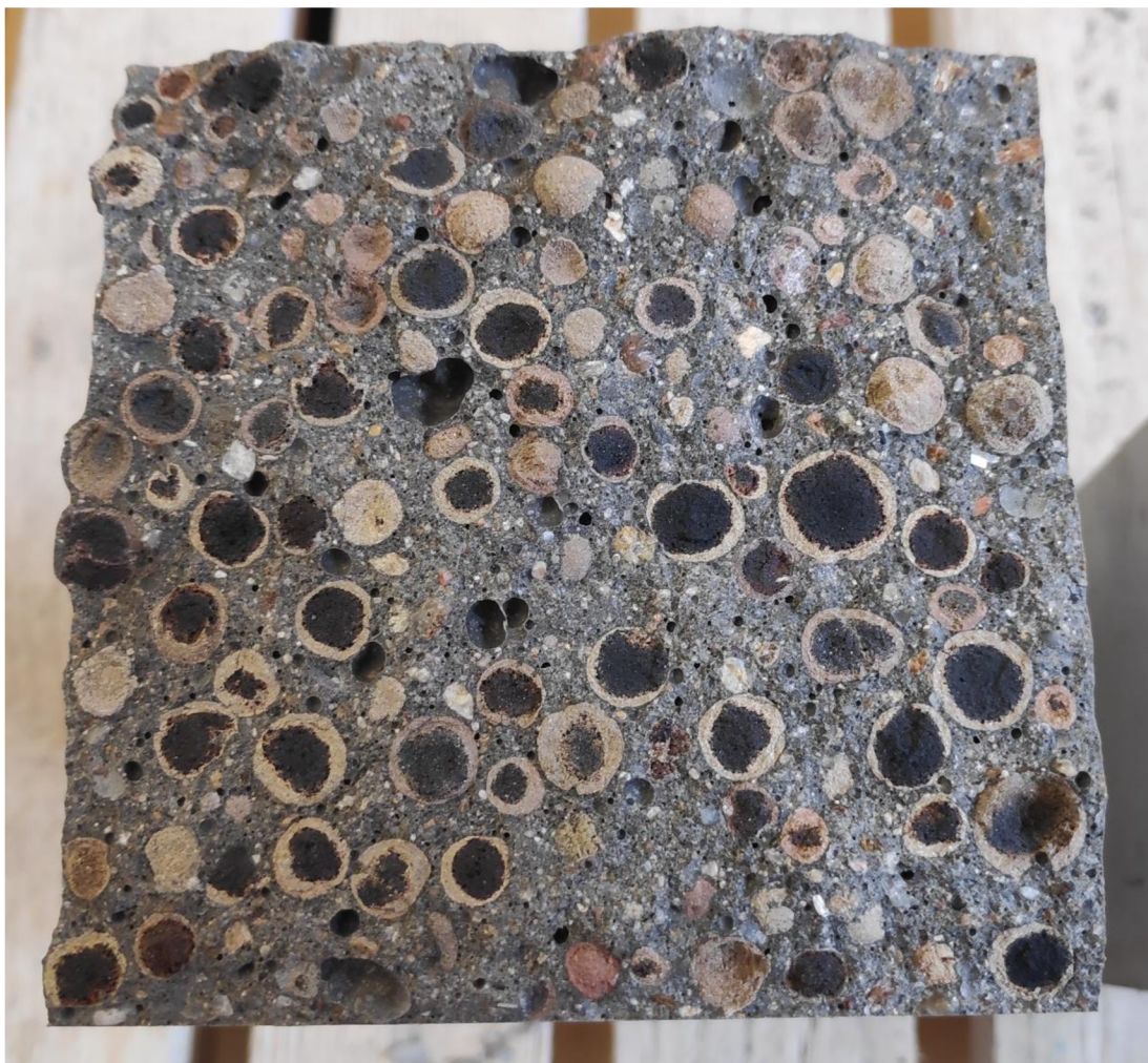
Obr. 44: Detail porušeného příčného řezu po zkoušce v tahu ohybem
