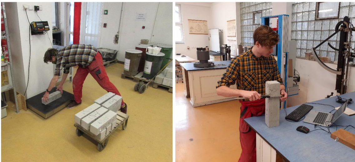
Obr. 16: Vážení a měření rozměrů zkušebních těles [fotoarchiv Ing. Dalibora Kocába, Ph.D.]
