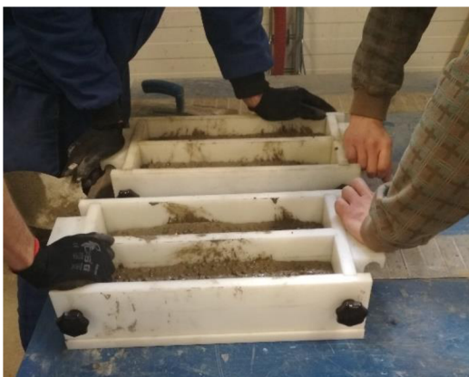
Obr. 38: Hutnění čerstvého betonu na vibrační desce
