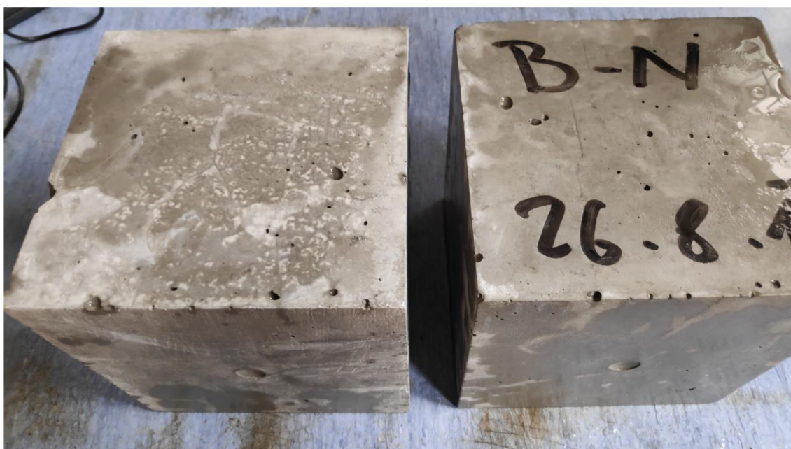
Obr. 45: Mapování mikrotrhlin na zkušebních krychlích B-N
