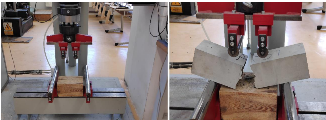
Obr. 20: Vlevo lis DELTA 6-300, vpravo zkoušený hranol porušený v tahu ohybem
