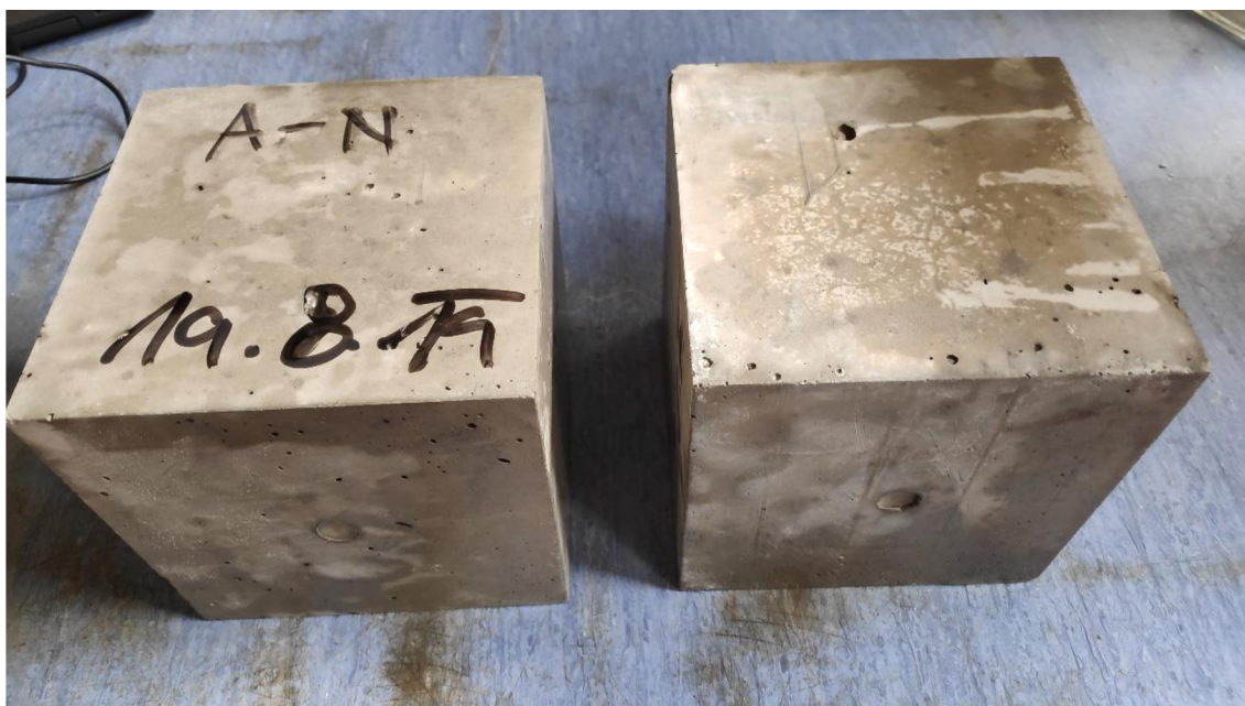
Obr. 46: Mapování mikrotrhlin na zkušebních krychlích A-N
